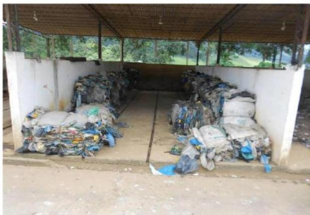
Material segregado e prensado na UTL pronto para ser reciclado.
