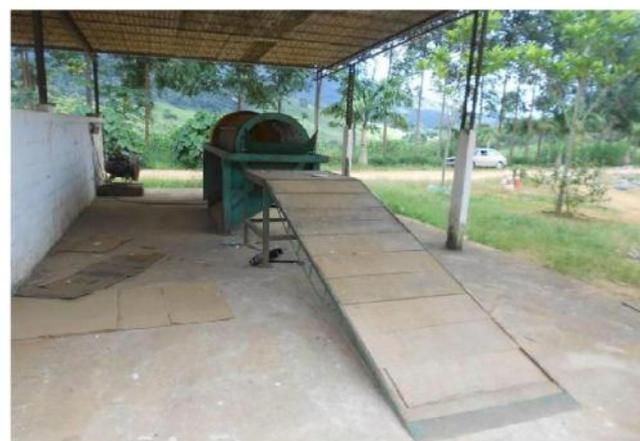
Peneira utilizada para refinar o material proveniente da compostagem, dessa forma, o material que fica retido é o rejeito e o material peneirado pode ser usado como composto orgânico.
